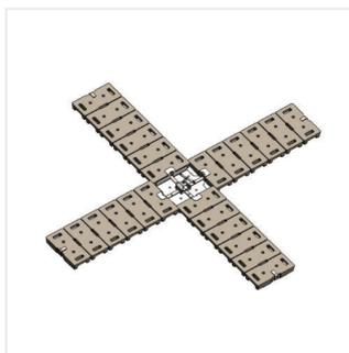
El Mobifor es un anclaje de cuerpo muerto para punto de anclaje de cubierta plana equipado con un disipador de energía INRS, 4 brazos de acero y 24 contrapesos de hormigón de 25 kg cada uno, fabricados en hormigón y partículas de acero.
