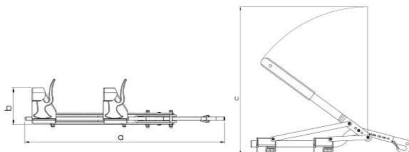
Tensado rápido y sencillo de cables de acero, como cables de transporte eléctrico, cables telefónicos y montaje de vallas. También es adecuado para arrastrar cargas. No es adecuado para la elevación.
