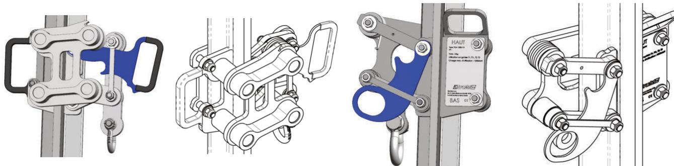
Las pinzas de estacionamiento de seguridad (SPC) están dedicadas a asegurar las plataformas elevadoras utilizadas en la industria de los ascensores al unir la plataforma al raíl guía. Se utilizan como dispositivo de seguridad secundario, un dispositivo de seguridad primario es obligatorio.
