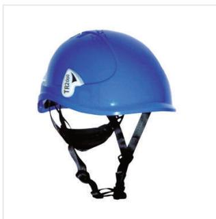
**Durante los trabajos en altura con equipos anticaída, se debe utilizar un casco certificado según la norma EN 397, con barbuquejo y 4 puntos de fijación y clasificado como EPI de categoría III.**
