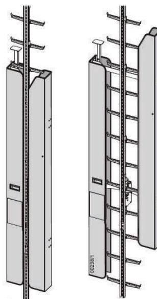
Chapa de seguridad galvanizada Puerta de seguridad galvanizada
